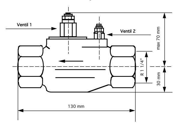
Verschneideeinrichtungen sind vollautomatisch arbeitende Mischventile für Brauchwasser- Enthärtungsanlagen. Die vorliegende Ausführung wurde speziell für Anlagen mit grösserem Wasserverbrauch entwickelt.
